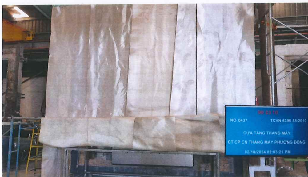
Ảnh 2: Mẫu thử tại phút thứ 3 của quá trình thí nghiệm
