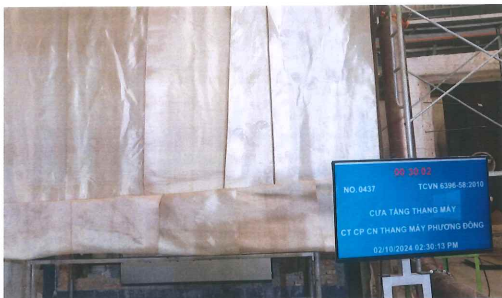
Ảnh 3: Mẫu thử tại phút thứ 30 của quá trình thí nghiệm
