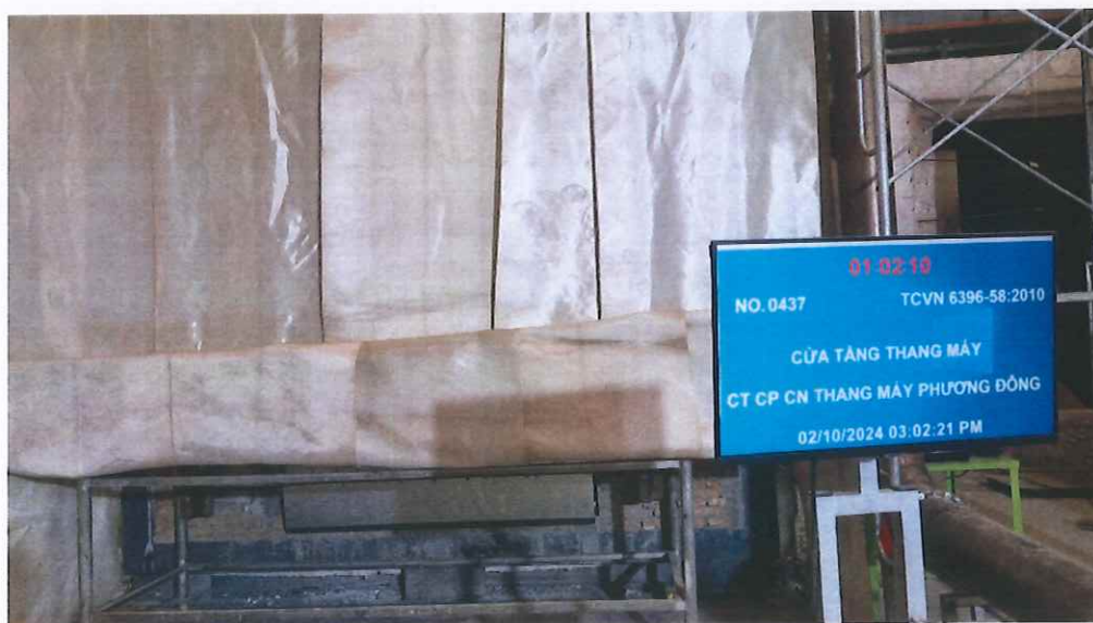
Ảnh 4: Mẫu thử tại phút thứ 62 của quá trình thí nghiệm
