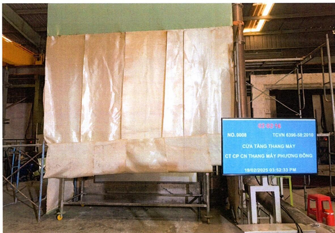
Ảnh 4: Mẫu thử tại phút thứ 122 của quá trình thử nghiệm
