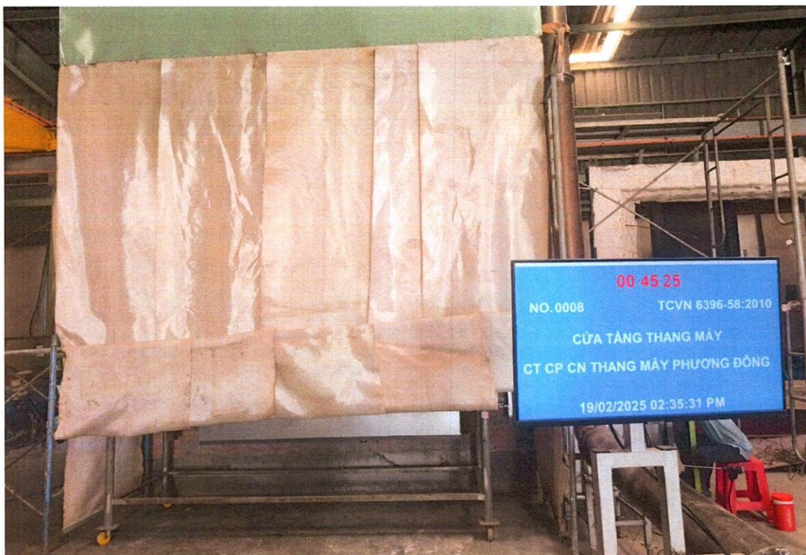
Ảnh 3: Mẫu thử tại phút thứ 45 của quá trình thí nghiệm
