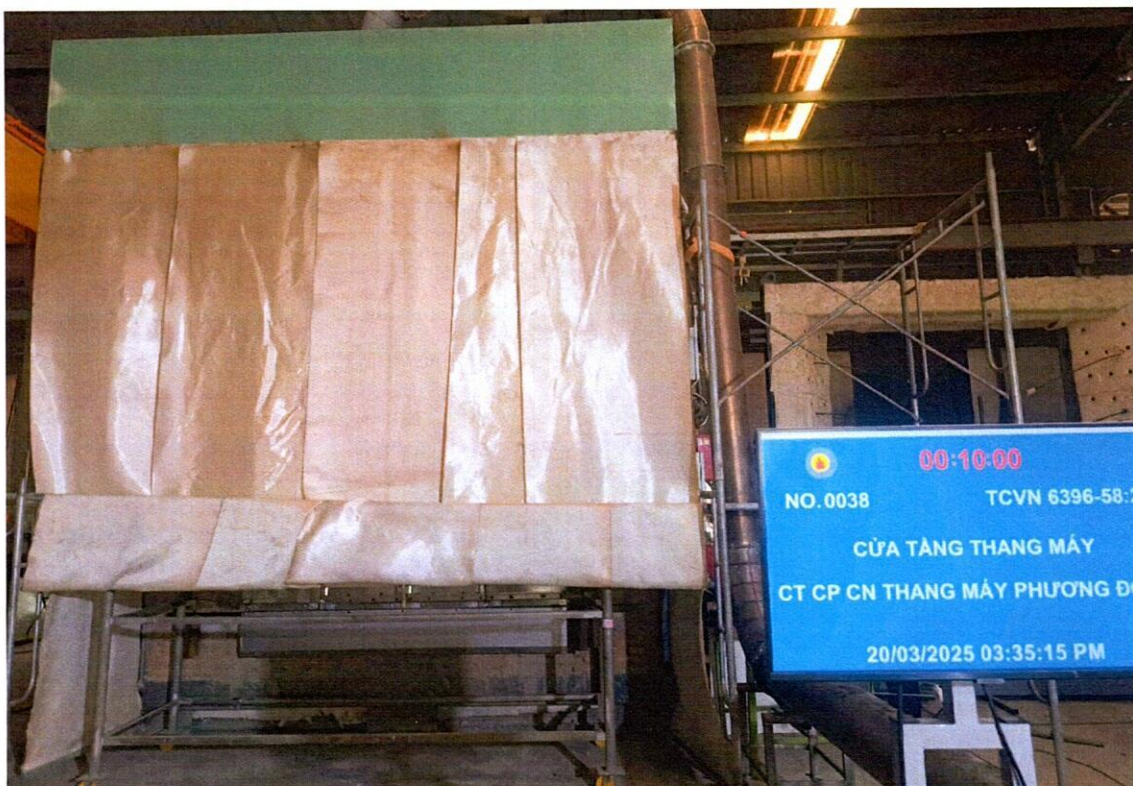
Ảnh 2: Mẫu thử tại phút thứ 10 của quá trình thí nghiệm
