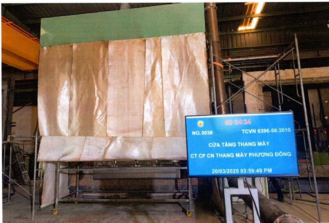
Ảnh 3: Mẫu thử tại phút thứ 34 của quá trình thí nghiệm
