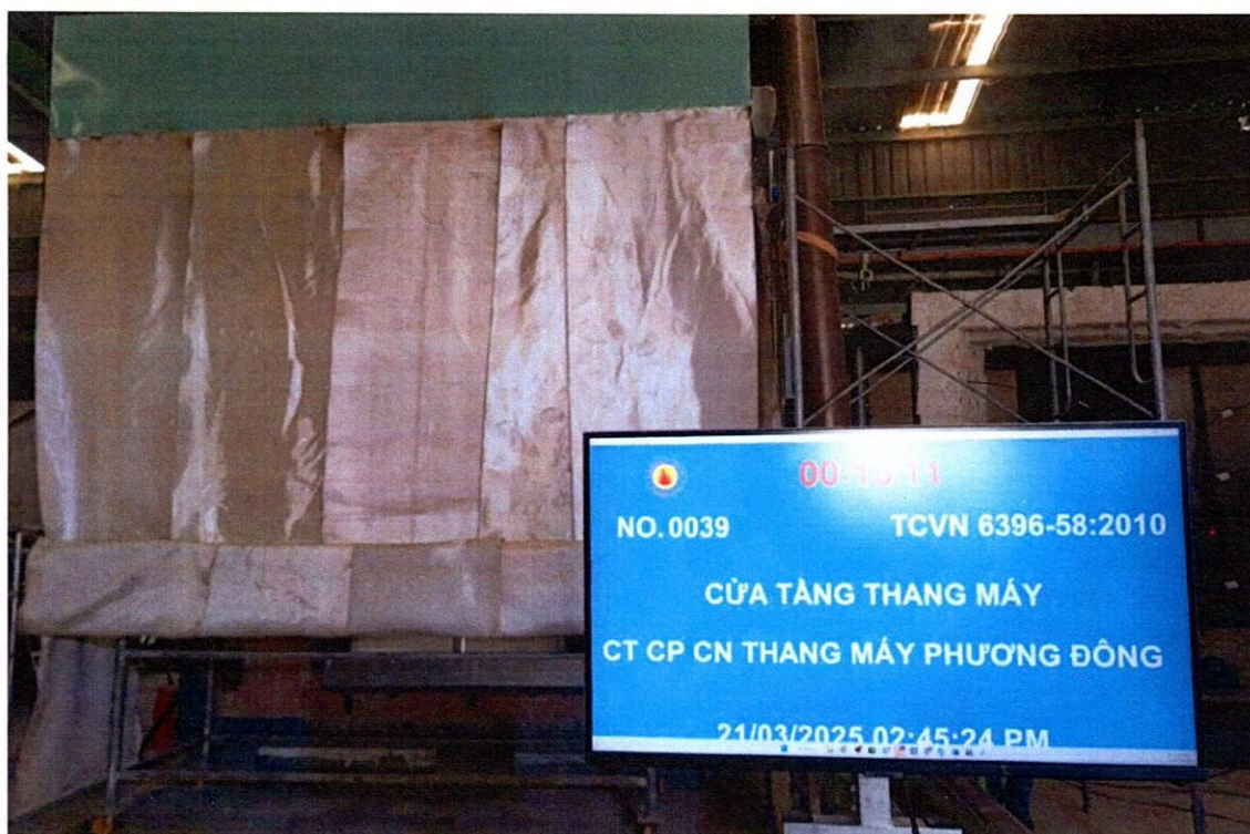
Ảnh 2: Mẫu thử tại phút thứ 15 của quá trình thí nghiệm
