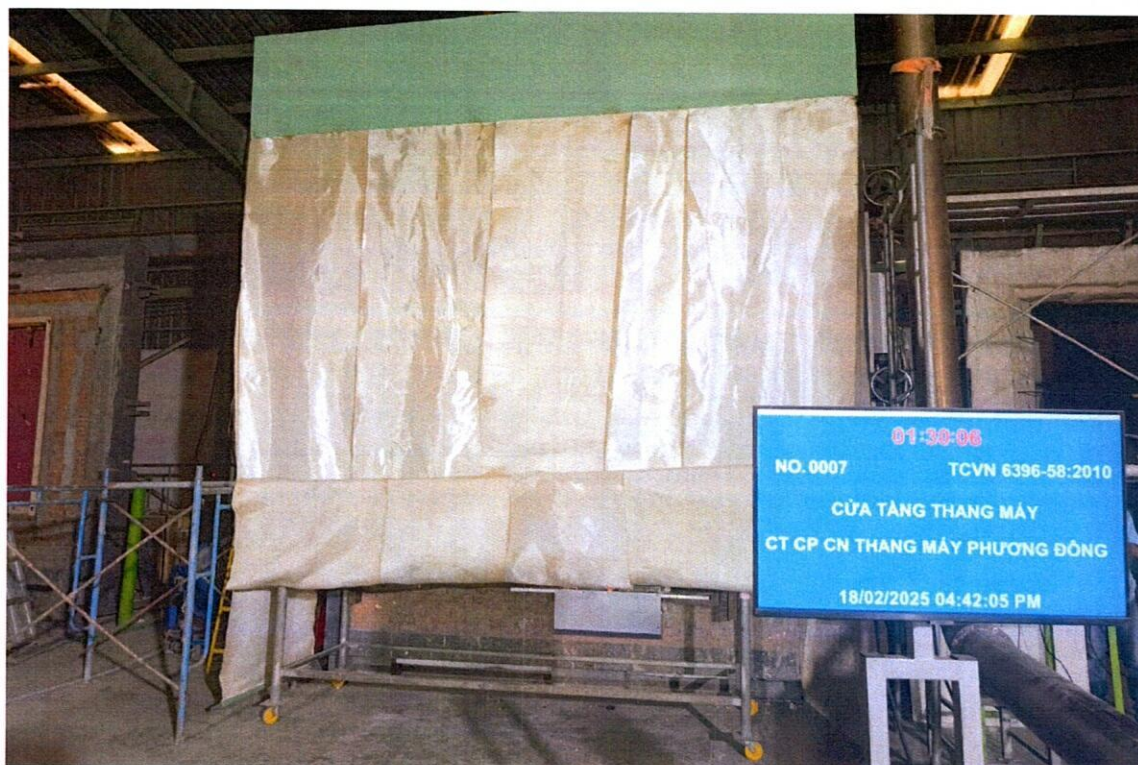
Ảnh 3: Mẫu thử tại phút thứ 90 của quá trình thí nghiệm
