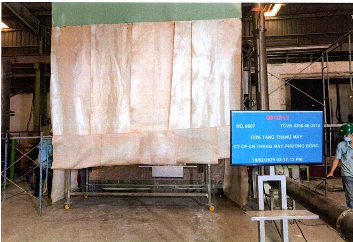
Ảnh 2: Mẫu thử tại phút thứ 5 của quá trình thí nghiệm
