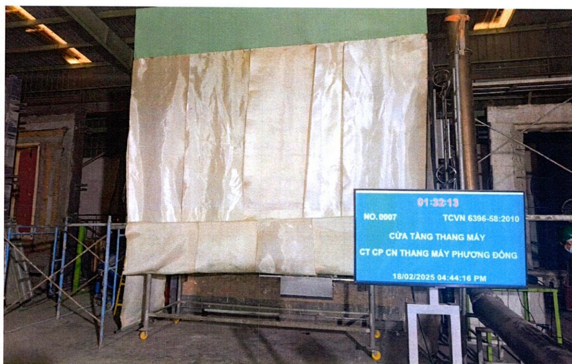
Ảnh 4: Mẫu thử tại phút thứ 92 của quá trình thử nghiệm
